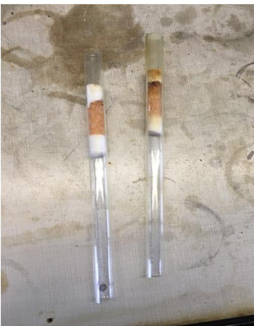
Ogni volta che ottenevamo le sostanze dalla sigaretta bruciata pesavamo il filtro attraverso la bilancia analitica, uno strumento di misura della massa molto preciso. Così facendo, sottraendo il valore finale da quello iniziale del filtro, abbiamo ottenuto il valore della massa di catrame presente in ogni sigaretta.
