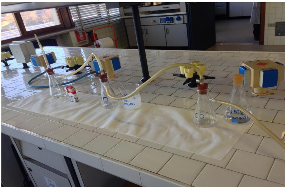
In quest'immagine la sigaretta accesa è collegata alla beuta vuota tramite un tubo con all'interno un filtro che trattiene il catrame depositato della sigaretta. L'ultima beuta della foto era collegata alla pompa a vuoto a sua volta collegata al rubinetto dal quale usciva l'acqua che azionava quest'ultima.
